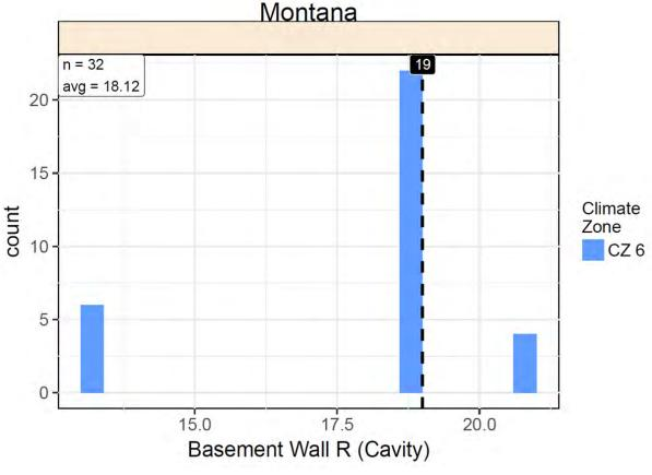
Figure 3.8. Basement Wall Cavity R-Values<sup>2</sup>
